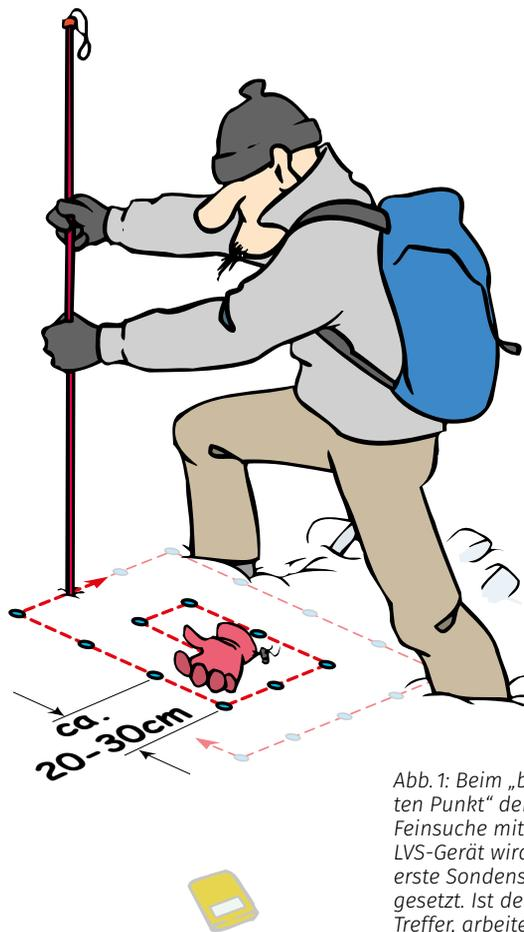
Abb. 1: Beim „besten Punkt“ der Feinsuche mit dem LVS-Gerät wird der erste Sondenstich gesetzt. Ist der kein Treffer, arbeitet man sich spiralförmig nach außen vor, bis man den Verschütteten spürt.
